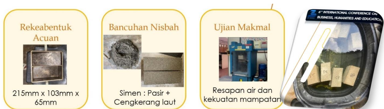
Rajah 3.2: Proses rekabentuk, ujian mampatan dan rendaman air 28 hari bagi ujian resapan
