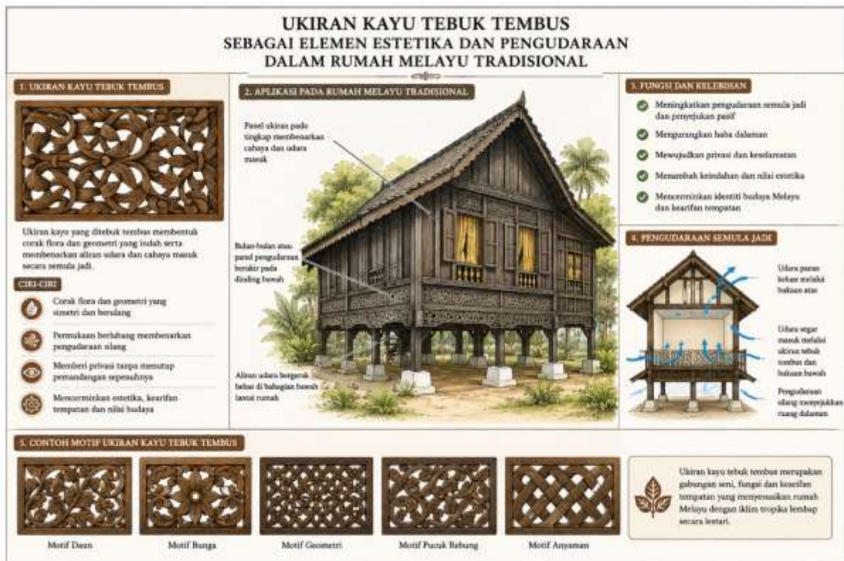
Rajah 4: Ukiran Kayu Tebuk Tembus sebagai Elemen Estetika dan Pengudaraan
