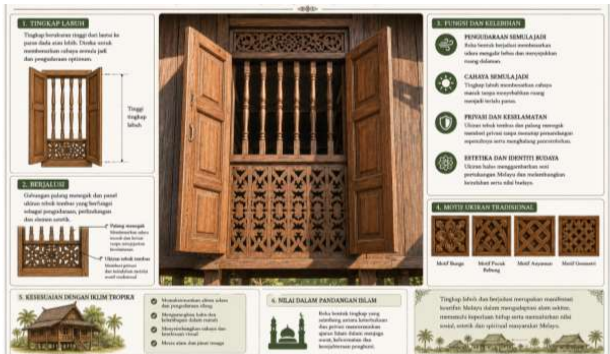
Rajah 8: Bentuk Tingkap Labuh dan Berjalusi dalam Rumah Melayu Tradisional Sumber: Ilustrasi Pengkaji
